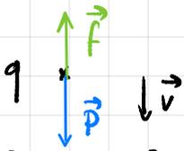
Mvt rectiligne et uniforme  $\Rightarrow \vec{a} = \vec{0}$  et  $\vec{P} + \vec{f} = \vec{0}$
