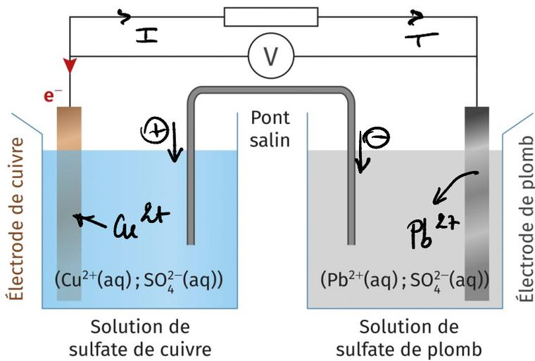
1/ Les électrons circulent dans le sens opposé au sens de circulation du courant électrique. (cf. schéma).
