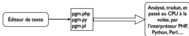
Un interpréteur **analyse** le code source d'un programme, le **traduit** en langage machine et fait exécuter le code par l'ordinateur.
