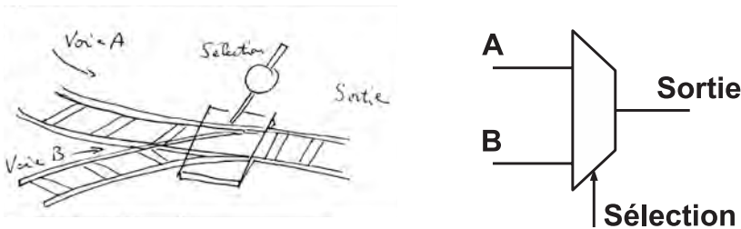
Multiplexeur à 2 voies
